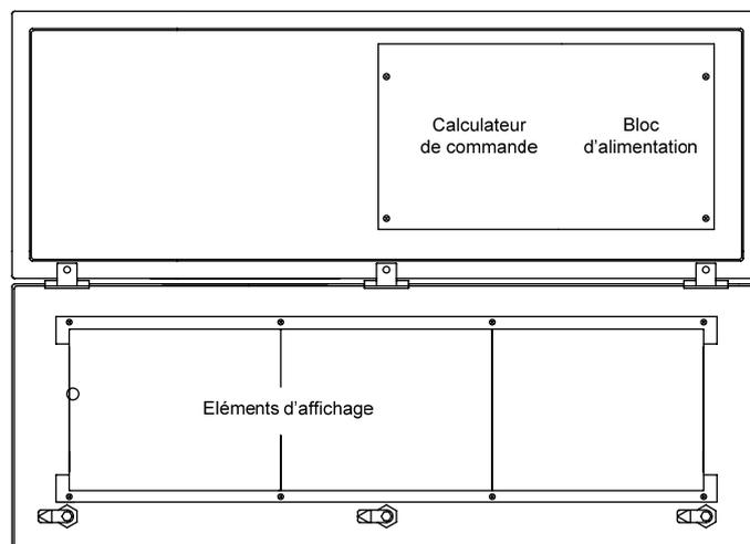
Technique d'affichage Selon les versions, les appareils sont équipés d'un affichage lumineux à LED ou d'un affichage réfléchissant à LRD® :
